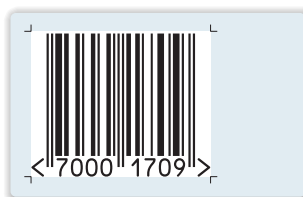
Rys. 279. Kod kreskowy EAN-8.
