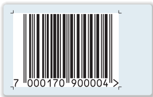
Rys. 280. Kod kreskowy EAN-13.
